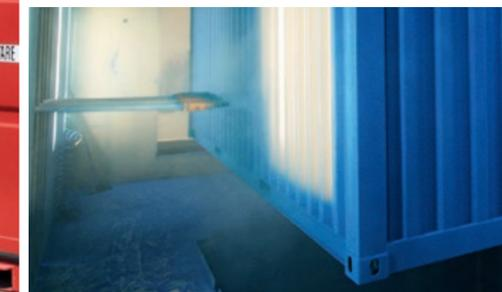
Lackierung mittels Pulverbeschichtung
